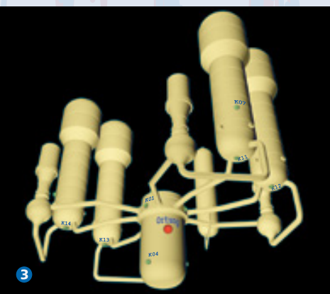
Bild 2: Aufbereitung zwecks einer 3D-Ortung. Darstellung beliebiger 4 Kanäle in den Formen: Rohdaten, Gefiltert, Relativdaten, Kurzzeit-RMS, Langzeit-RMS und Kurtosis
