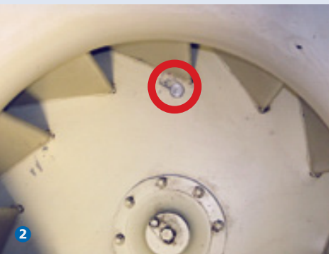
Bild 2: Gewuchteter Lüfter mit gesetzter Ausgleichsmasse (roter Kreis)
