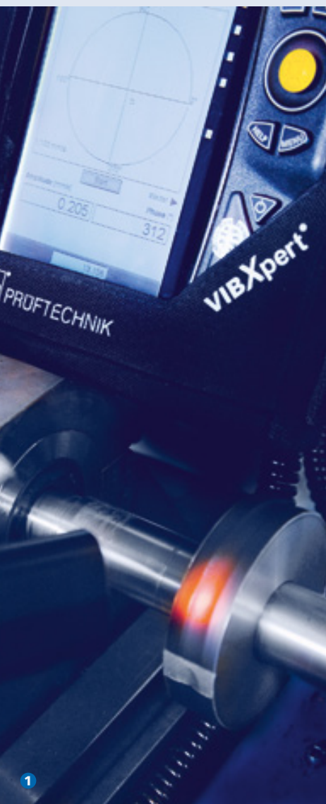
Bild 1: Betriebswuchten an offener Welle: Der Mess-Analysator mit Wellenmarken-Laser im Einsatz
