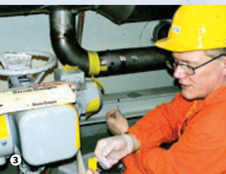
Bild 1: Testschläge zur Bestimmung der Körperschallübertragungen in einem Kernkraftwerk
